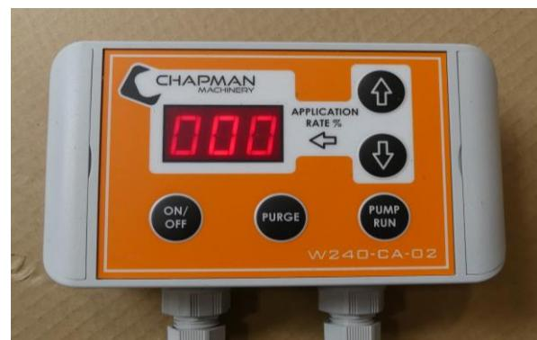
**PURGE:** Cuando se pulse este botón, la bomba funcionará de forma continua, lo cual resulta ideal para eliminar obstrucciones, purgar el sistema de aire o lavar a fondo el matahierbas con agua después de usarlo.
