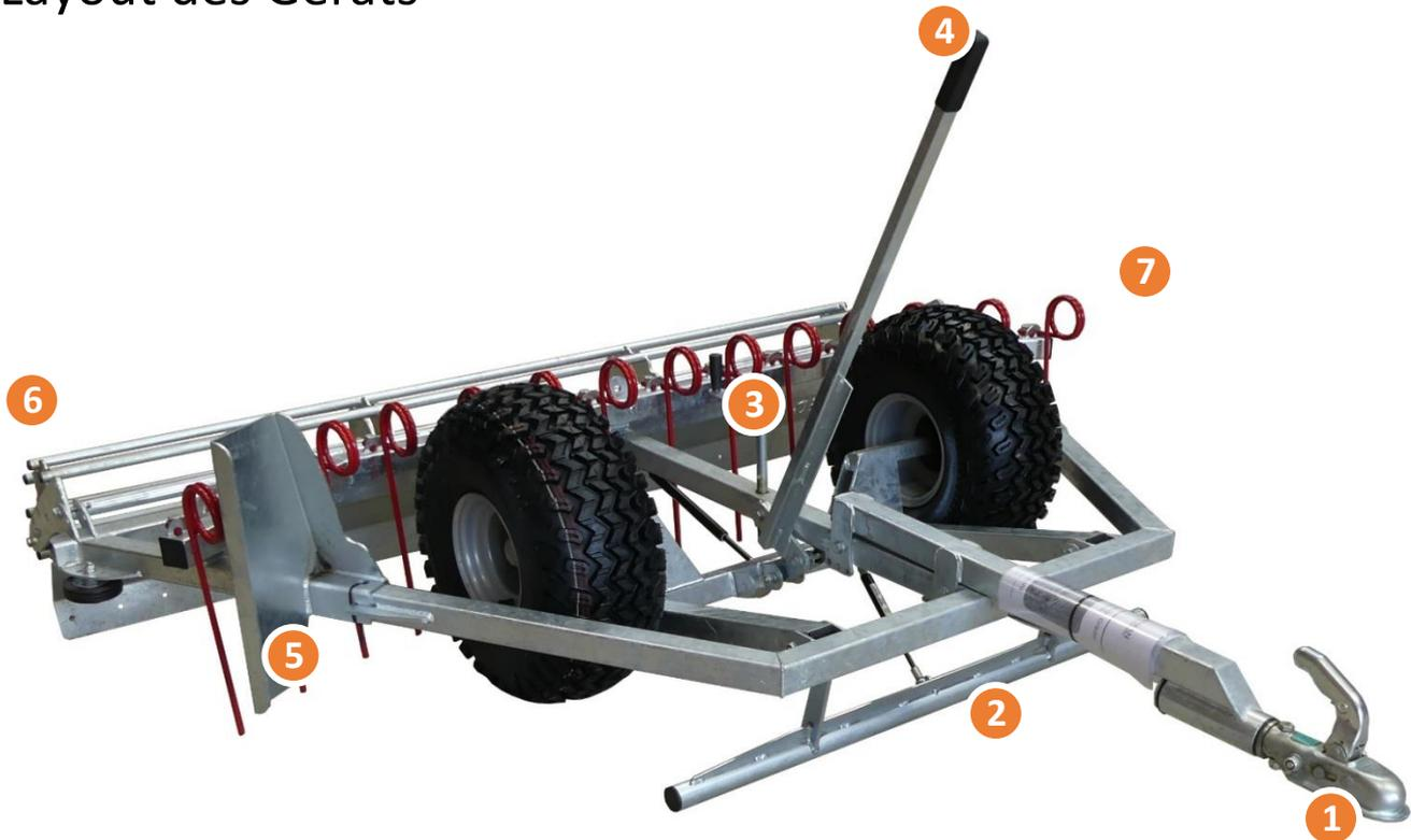
Kupplung (1); Radspur-Nivellierstange (2); Tiefenbegrenzung (3); Transporthebel (4); Perimeterschild (5); Hintere Walze (6); Zinken (7)
