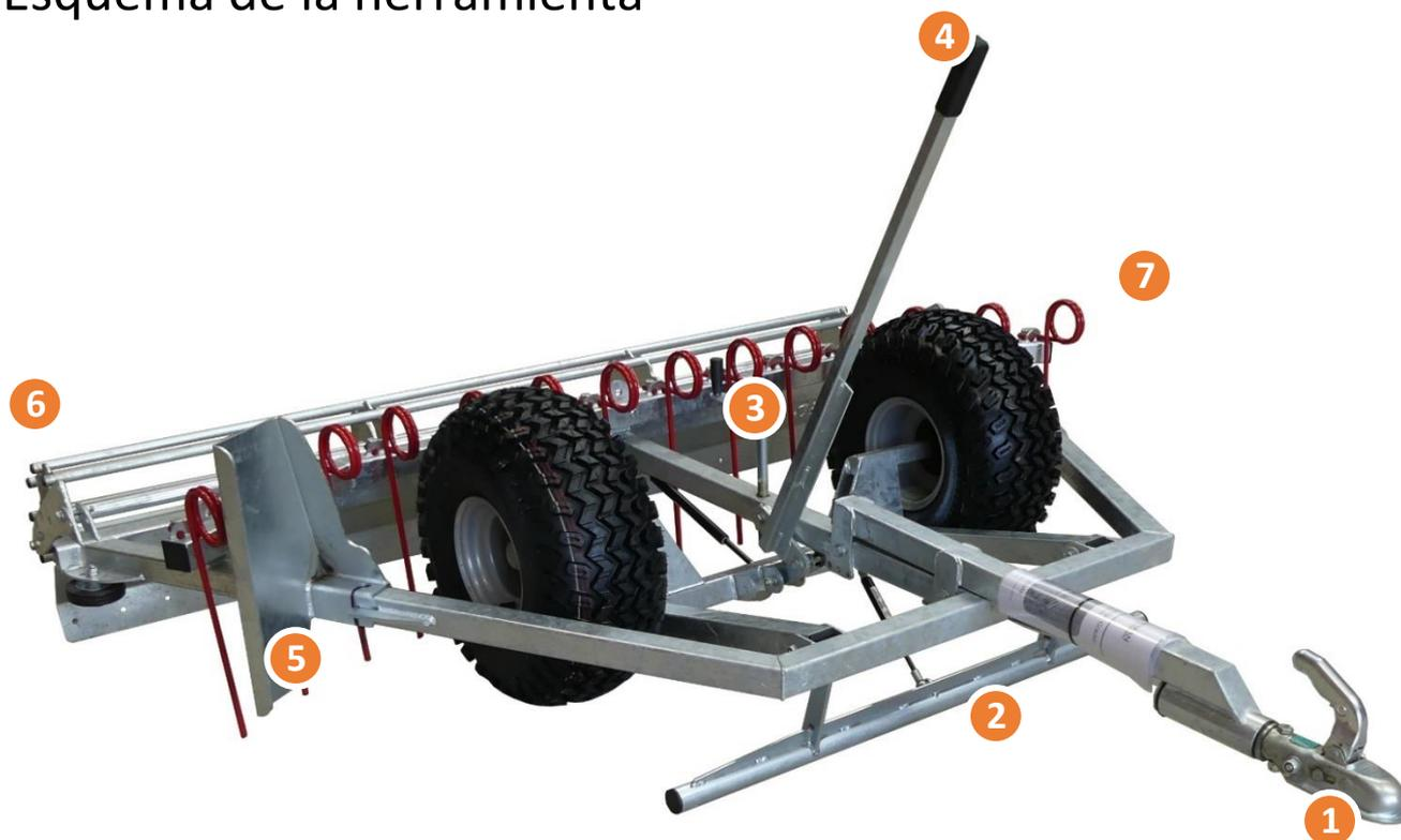
Acoplamiento (1); barra niveladora de surcos de rueda (2); límite de profundidad (3); palanca de transporte (4); pala perimetral (5); rodillo trasero (6); dientes (7)
