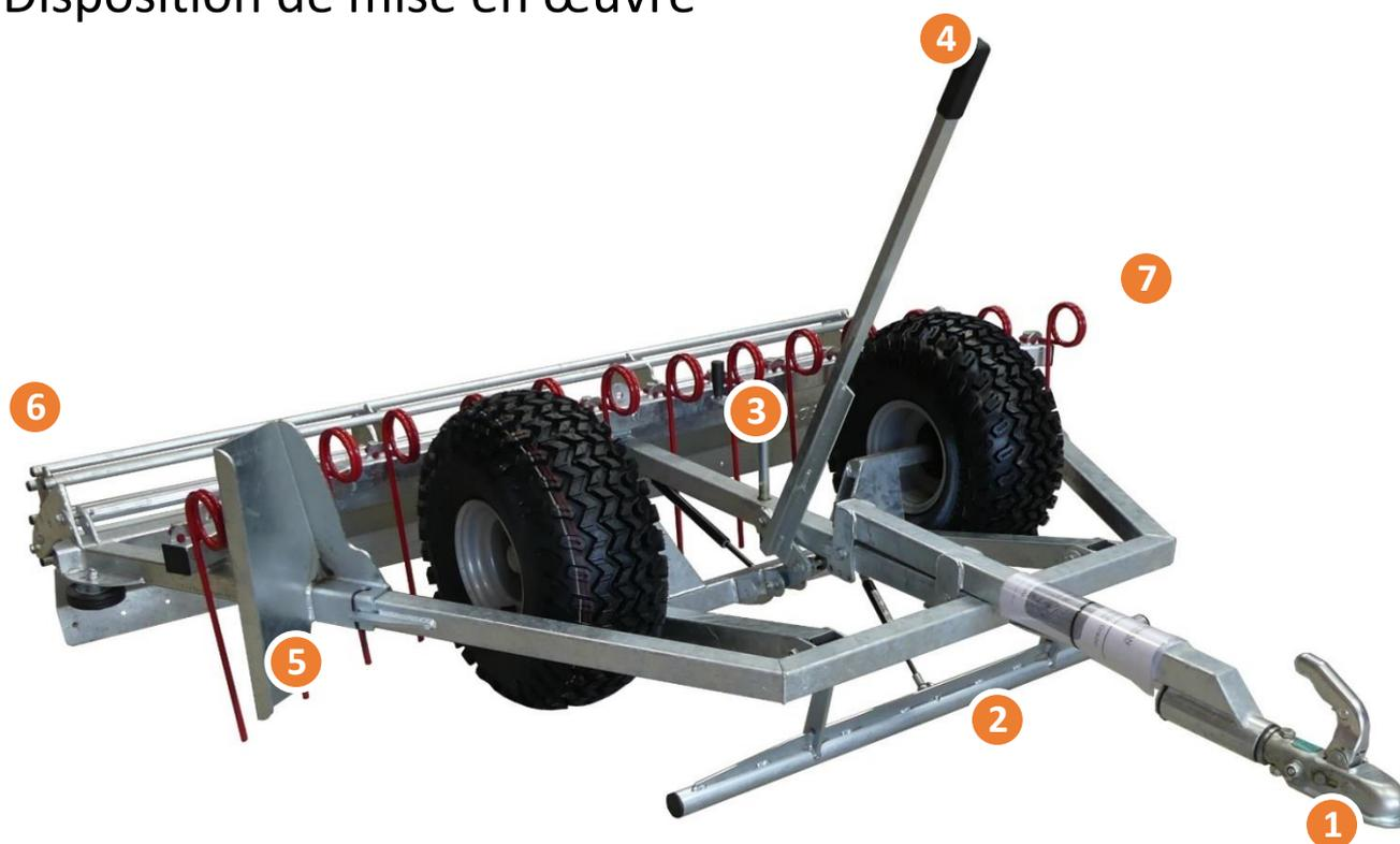
Accouplement (1) ; Barre de nivellement de bande de roulement (2) ; Limite de profondeur (3) ; Levier de transport (4) ; Lame périphérique (5) ; Rouleau arrière (6) ; Dents (7)
