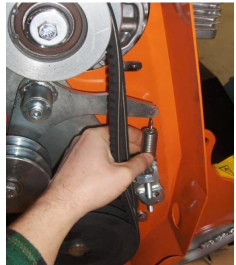
7. Aflojar el tornillo de ajuste del tensor con dos llaves de 17 mm, que se muestran más arriba como la parte «C». Hay que aflojar el ajustador del tensor hasta que el muelle pueda retirarse con la mano del brazo del tensor, tal y como se muestra en la imagen de la derecha.
