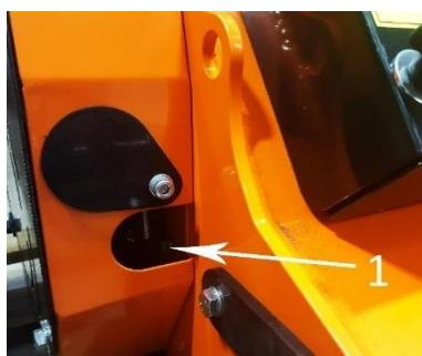
1. Rotorlager der Antriebsseite
