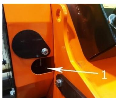
1. Roulement du rotor côté entraînement
