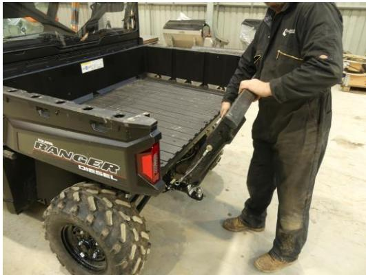
2. Laden Sie den MF350 mit Hilfe von Gabelstaplerschlitten oder geeigneten Hebehilfen, die für das Leergewicht der Platte ausgelegt sind, auf die Ladefläche. Wenn der Trichter zum ersten Mal montiert wird und "auf dem Kopf stehend" geliefert wurde, kann er vorsichtig von 2 Personen auf die Ladefläche des Pickups gerollt werden, wie unten gezeigt. Achten Sie darauf, dass der Schaltkasten und die Verkabelung bei diesem Vorgang nicht eingeklemmt oder beschädigt werden!
