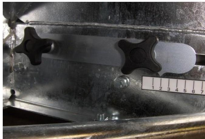
Llenar la tolva hasta la mitad con el pienso a repartir. Con la máquina sujeta al vehículo tractor y en terreno llano, encender la caja de control y depositar 20 descargas de pienso en un cubo. Pesar el pienso depositado y dividir el peso por el número de descargas (en este caso, 20) para obtener el peso por descarga.
