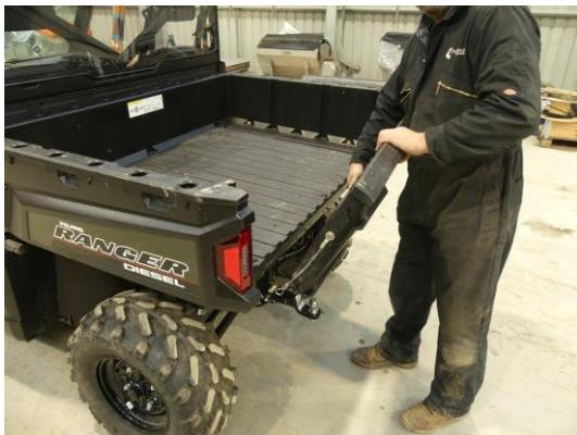
9. Centrez la trémie dans la benne et fixez-la à l'aide des 4 sangles à cliquet fournies, 2 sangles par côté. Les sangles à cliquet doivent être montées de manière croisée, comme indiqué ci-dessous ! Il incombe à l'utilisateur de s'assurer que l'appareil est solidement installé dans la benne.
