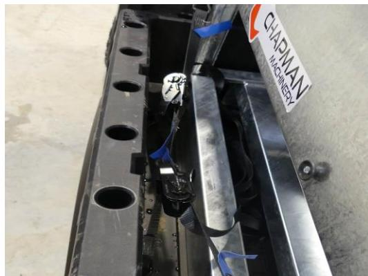
4. Bringen Sie die Stützstange für die Abdeckung an, um ein Durchhängen der Abdeckung zu verhindern (siehe unten). Befestigen Sie die Abdeckplane oben auf dem Trichter.
