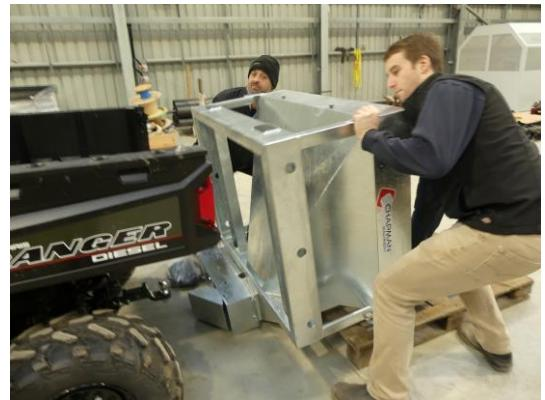
3. Zentrieren Sie den Trichter auf der Ladefläche und befestigen Sie ihn mit den 4 mitgelieferten Ratschengurten, 2 Gurte pro Seite. Die Ratschengurte müssen wie unten gezeigt überkreuzt angebracht werden! Es liegt in der Verantwortung des Benutzers, sicherzustellen, dass das Gerät sicher auf der Ladefläche befestigt ist.
