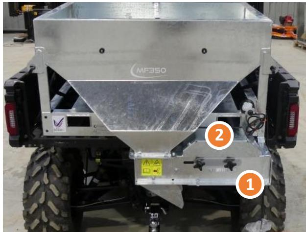
5. Il ne devrait pas être nécessaire de retirer la plaque de glissière pour accéder au capteur. Toutefois, si vous devez retirer la plaque de glissière pour y accéder, vous pouvez le faire en déclipsant le ressort de la plaque de glissière et en retirant les 5 roulements et les boulons associés qui fixent la plaque. NOTEZ LE NOMBRE DE RONDELLES, CAR ELLES DOIVENT ÊTRE REMISES EN PLACE DANS LE MÊME ORDRE POUR ASSURER LE BON FONCTIONNEMENT DE LA GLISSIÈRE.
