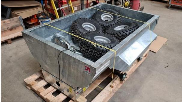
2. Sobald die Deichsel entfernt ist, fädeln Sie den Handregler durch die Endplatte
