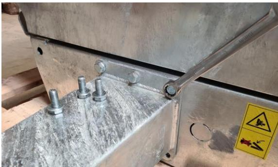
14. Levantar la parte trasera del remolque con un gato hidráulico o similar (utilizar soportes de eje en caso necesario) e instalar las ruedas. Apretar las tuercas de las ruedas a 50 N·m. **COMPROBAR TODAS LAS TUERCAS Y PERNOS DESPUÉS DE 1 HORA DE USO.**
