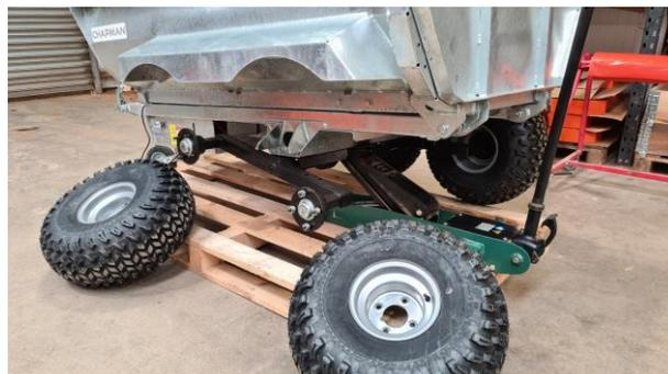
10. Procédez de la même manière pour le côté suivant, en veillant à ce que toutes les roues des deux côtés soient complètement serrées. Attachez au véhicule de remorquage pour retirer la palette en toute sécurité.
